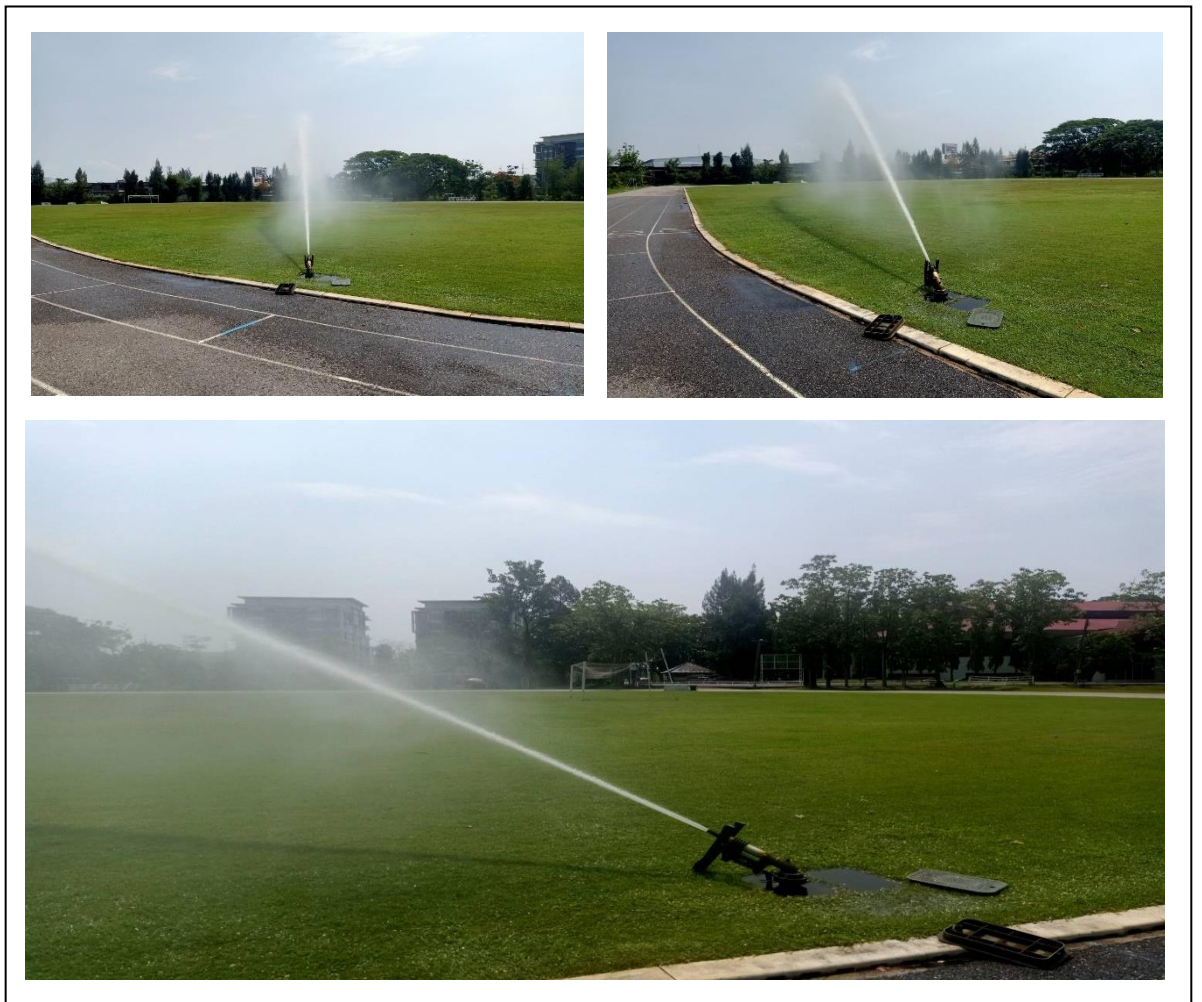
ภาพที่ 7 ภาพหัวฉีดปีกกัน (Big Gun Sprinkler)
